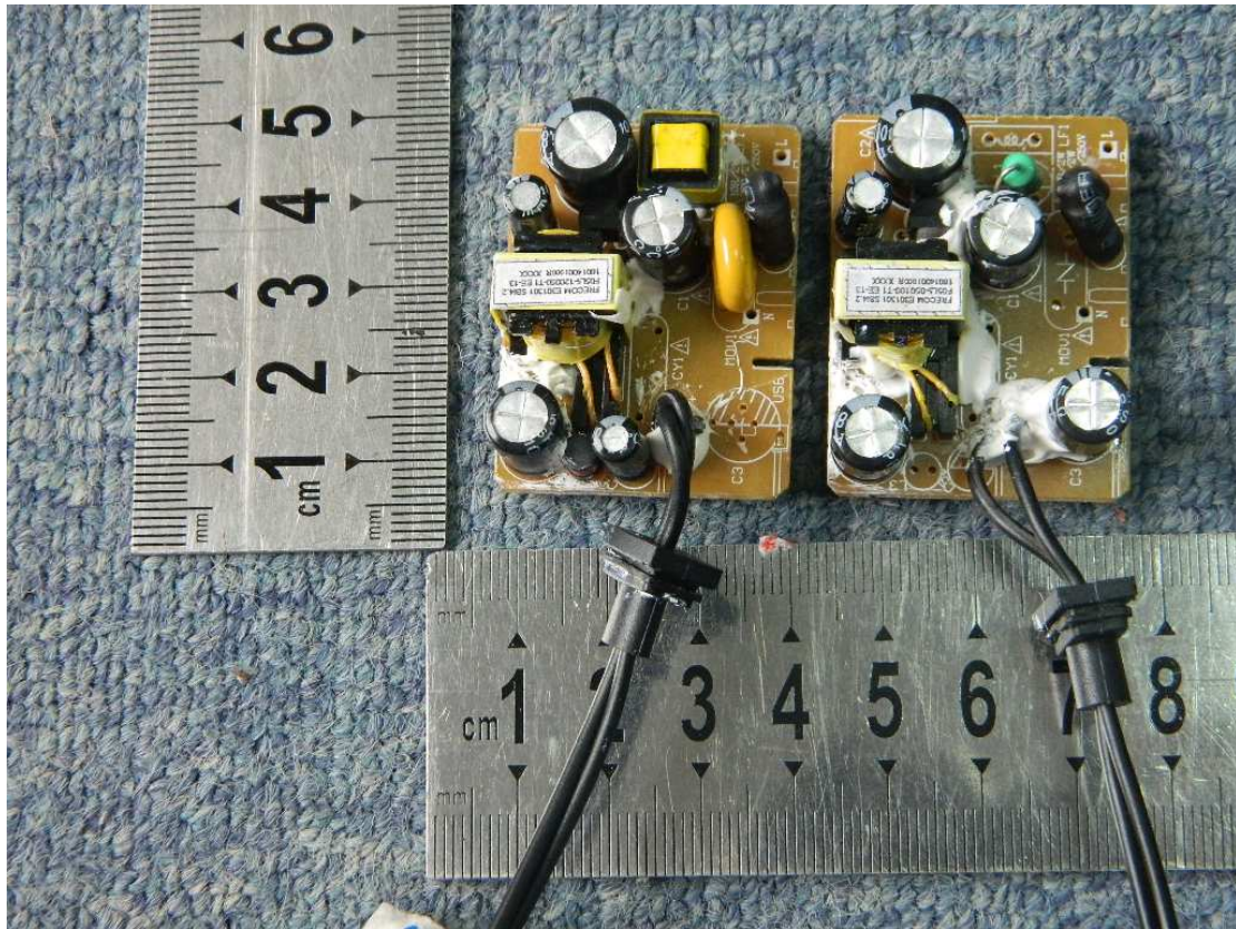
图1 主板正面 (左F05L5-130047SPAC、右F05L5-050100SPAC)
